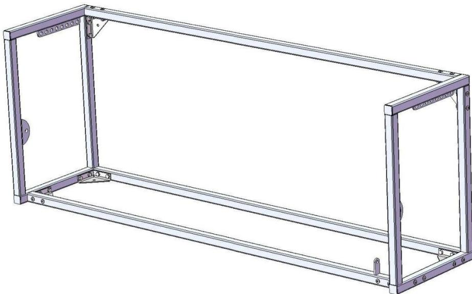
при помощи угловых кронштейнов, болтов М8\*30 и колпачковых гаек под Шестигранный ключ
